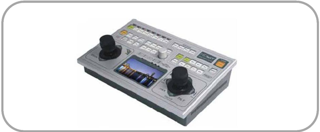
본 장비는 연구소와 옥외에 설치된 카메라를 유선(모뎀)으로 연결하여 원격 제어하는 장비로서 연구소에서 옥외에 설치된 Camera, Zoom Lens, PanTilt 등을 제어할수 있는 시스템입니다. 외부의 온도로부터 차폐되며 내부의 카메라를 보호할수 있으며, 전면에 부착되어 유리창에는 Wiper 와 Washer 를 사용하여 항상 깨끗한 화면을 볼수 있게 하였다.
