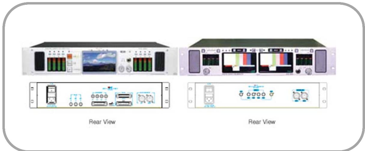
BTA-202H는 2CH HD/SD-SDI 신호와 4CH의 AES/EBU, 8CH의 Analog Audio 신호를 선택하여 모니터링 할 수 있는 장비이다. 전면의 스위치로 입력된 신호를 선택 할 수 있으며 HD/SD 4.3" LCD Monitor와 8CH 25 Dot LED Level Meter, 스피커로 신호 상태를 확인 할 수 있다. 또한 Analog 2CH로 출력하는 Line Out 단자가 있다.
