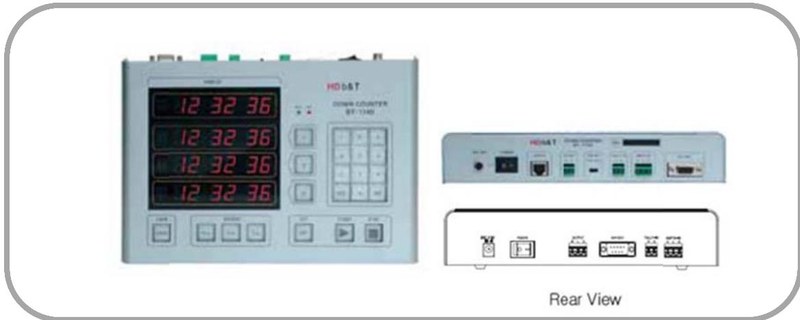
BT-114D는 프로그램 제작 시 프로그램 시간을 Down Counter하는 장비로서 외부SMPTE Time Code 및 자체 Clock 동기 신호를 선택하여 Down Counter할 수가 있습니다. 3개로 구성된 Down Counter는 시간을 설정하여 선택에 따라 1개 또는 전부를 Counter할 수 있을 뿐만 아니라 외부에 연결된 Digital Time Display에 연동하여 사용할 수도 있어 다양한 프로그램을 제작할 수 있습니다.
