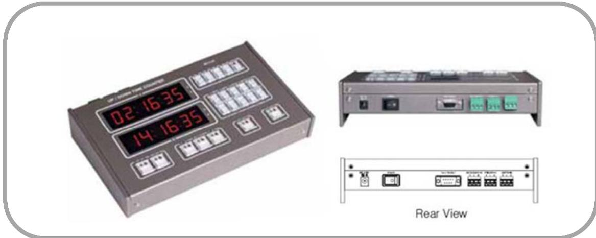
BT-114T는 프로그램 제작 시 프로그램 시간을 Counter하는 장비로서 외부 SMPTE Time Code 및 자체 Clock 동기 신호를 선택하여 Counter할 수가 있습니다. 2개로 구성된 Counter는 시간을 설정하여 선택에 따라 1개 또는 전부를 Counter할 수 있을 뿐만 아니라 외부에 연결된 Digital Time Display에 연동하여 사용할 수도 있습니다.
