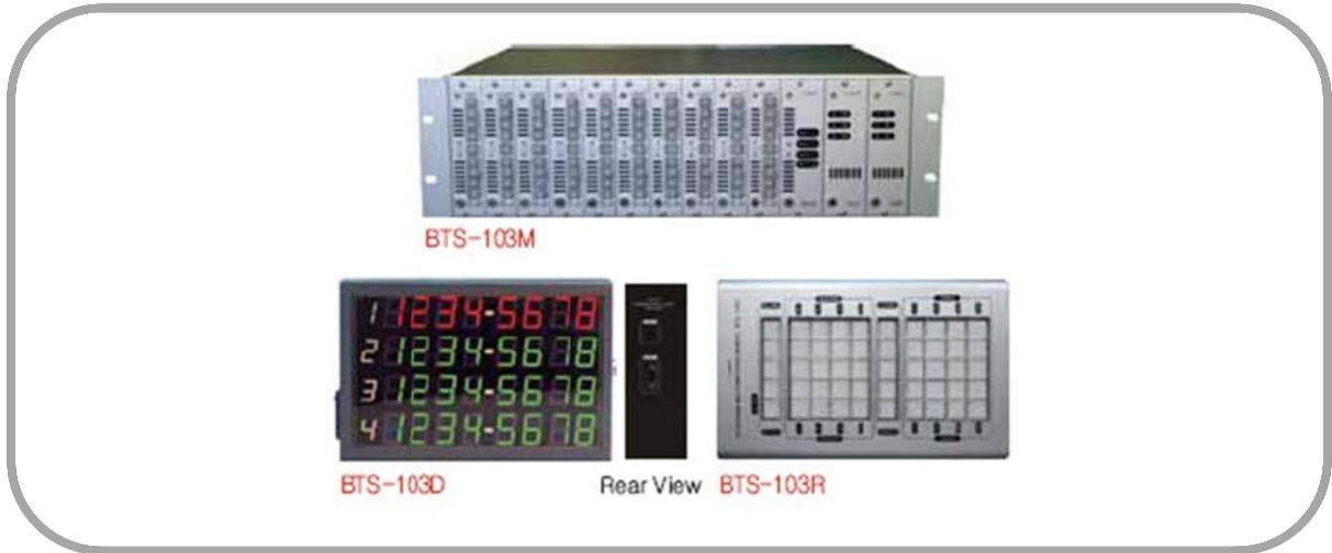
BTS-103D는 전화 회선을 이용하여 청취자와 연결하여 방송하는 장비입니다. 1입력의 회선으로 구성된 Module을 10장까지 장착이 가능합니다. 전화 회선의 접속상태, 대기상태 그리고 다양한 운용상태를 손쉽게 확인 및 제어가 가능하도록 설계 하였으며, 전원 공급기는 주, 예비 방식으로 구성하여 안정적으로 동작하도록 하였습니다. 시스템 구성은 Main Unit와 Remote / Number Display로 구성되어 있습니다.
