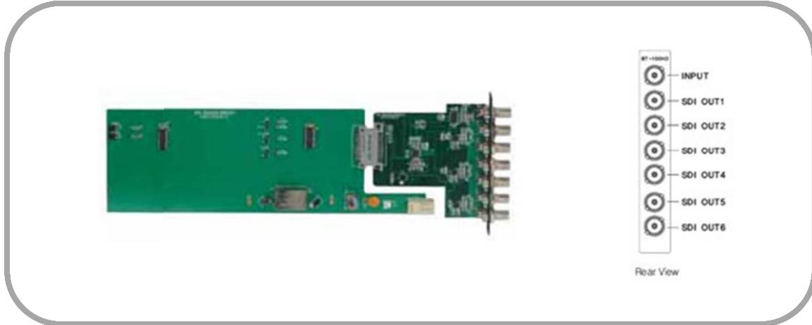
BT-100HD는 SMPTE292M(1.485Gbps, 1.485/1.001Gbps) 또는 SMPTE259M-C비디오 신호 규격을 만족하는 HD/SD SDI 분배기 입니다. BT-100HD는 SDI입력 신호를 Equalizing, Re-Clocking 회로를 거쳐 분배 및 증폭하여 타 장비의 입력에 신호를 공급합니다.
