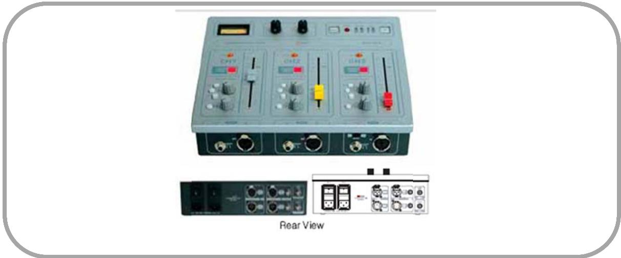
BCU-304L는 방송 스포츠 중계 등에서 아나운서와 해설자가 HEADSET을 이용하여 프로그램을 모니터하며 중계방송을 진행하기 위한 장비입니다. 4W 전용선을 이용하여 구성이 가능하며, MIC의 Gain조정 및 분배, 각 HEADSET의 Level을 개별로 제어가 가능한 장비입니다. 전원은 주, 예비 방식으로 되어 있어 안정적으로 동작할 수 있도록 설계 하였습니다.
