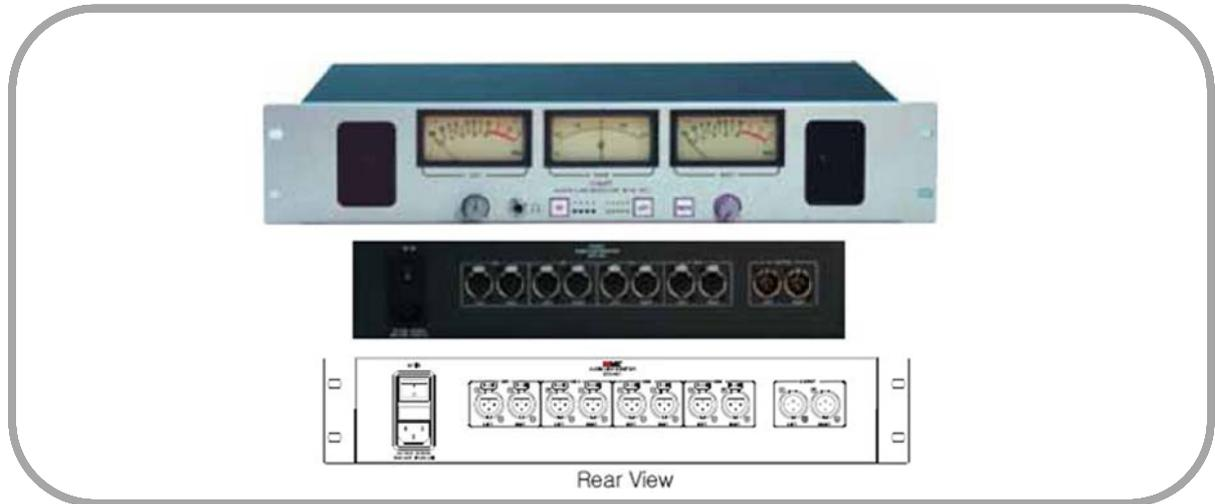
BTA-401 은 입력되는 오디오 신호가 정상적인지를 모니터 할 수 있는 장비로 Analog(Stereo) Audio 입력 4 채널을 수용하여 각각의 채널의 음량을 VU Meter 와 스피커로 모니터하며 동시에 Line 출력을 할 수 있는 Analog Audio Line Monitor 장비이다. 또한 위상 Meter 을 통해 동 위상 또는 역 위상 확인이 가능하며 입력감도 설정을 5 단계로 할 수 있다.
